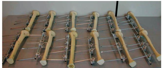
Figura 4 – Foto de um grupo de modelos com fixador e montagem barra única.
