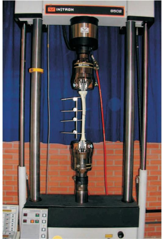
Figura 3 – Modelo de teste adaptado à máquina de testes Instron®
